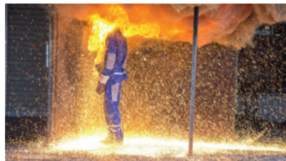
Störlichtbogen und Auswirkung auf den Bediener der Anlage (Quelle: RWE-Eurotest)
