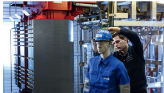
Vorbereitung Störlichtbogenprüfung (Quelle: RWE-Eurotest)
