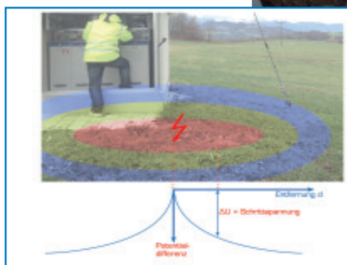
Anzeige einer unzureichenden Erdung bzw. gefährlichen Schrittspannung im Display. Am IKI-23 kann außerdem ein externer LED-Blinkgeber angeschlossen werden, der z.B. auf der Außenseite der Station montiert ist und die Gefahr anzeigt.
