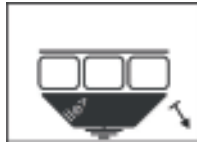
Intermittierende Erdfehler-Anzeige mit Richtungsangabe
